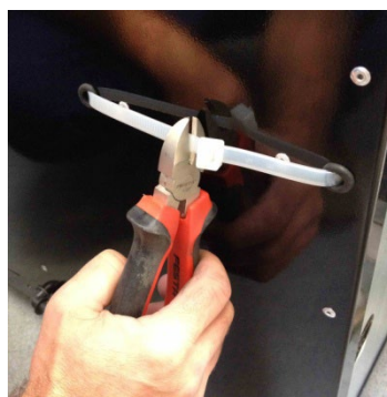
Abbildung 2: Verwenden Sie eine Zange oder ein anderes geeignetes Werkzeug, um das Band zu schneiden.
