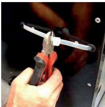
Obr. 2: Prerežte pásku vhodným nástrojom.
