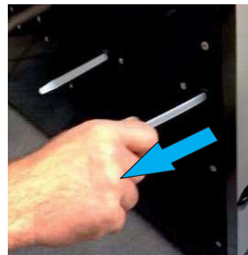
Obr. 3: Nakoniec vytiahnite pásku so zariadenia a odstráňte ju.
