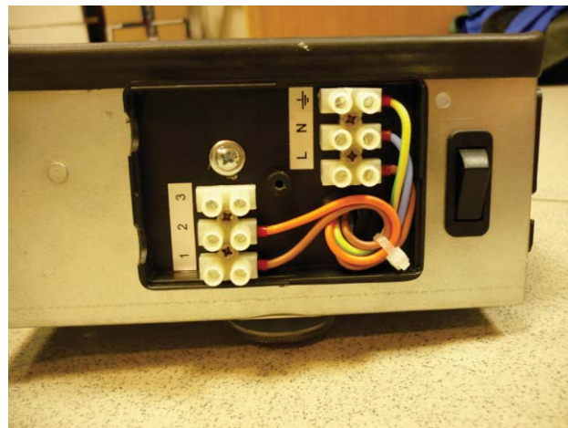
EBERLE připojení (1 k 1, 2 k 2, 3 k 3) a hlavní napájení (L, N, G)
