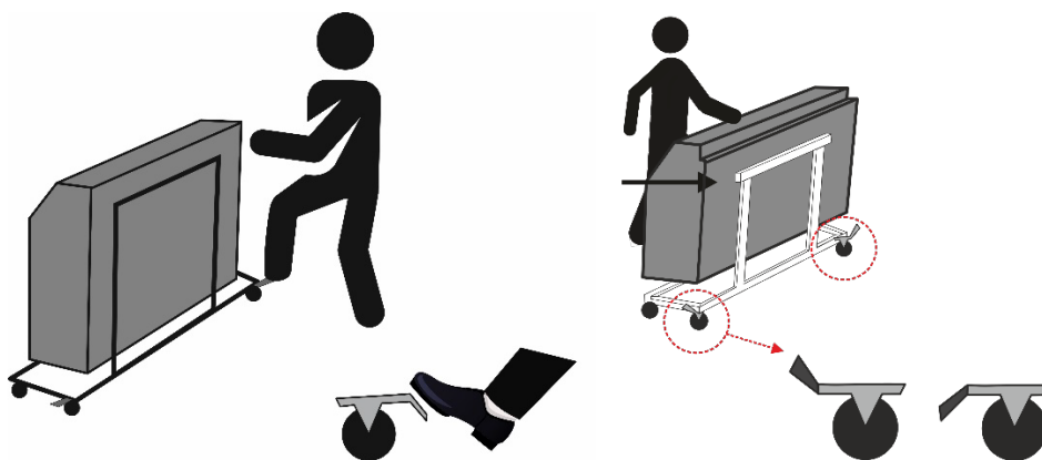
Imagen 1 Después de mover Athmoss en el soporte móvil al sitio de aplicación, asegure el freno de la rueda (bloqueo). El freno de la rueda se bloquea cuando la palanca del freno está bajada. El freno de la rueda se suelta cuando la palanca está levantada.
