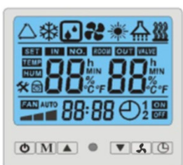
Obrázok: Displej ukazujúc všetky jeho indikátory v momente kedy je tepelné čerpadlo napojené na zdroj napätia.
