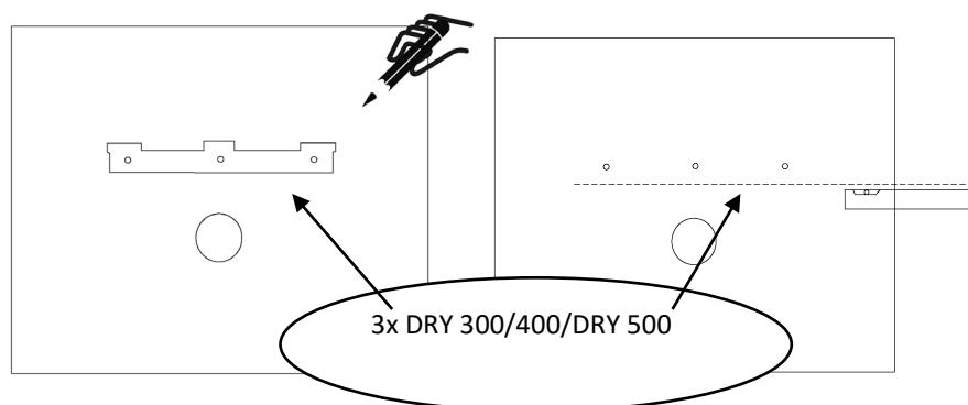
3. Vŕtať musíte: **3 diery pre nástennú konzolu DRY300/400/500, 2 diery pre zaistovacie skrutky DRY300/400/500, otvor Ø 100mm pre prívod čerstvého vzduchu DRY300/400/500** (v prípade, že Váš odvlhčovač je vybavený týmto príslušenstvom, ktoré je na vyžiadanie).
