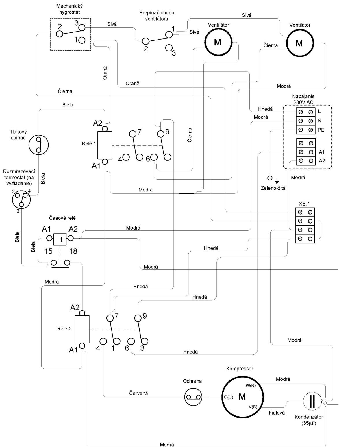
**Poznámka:** A1-fáza A2 – nulák pre ovládanie spolupracujúcich prvkov na prívod čerstvého vonkajšieho vzduchu – žalúziových lamiel so servopohonom a stenového odťahového ventilátora
