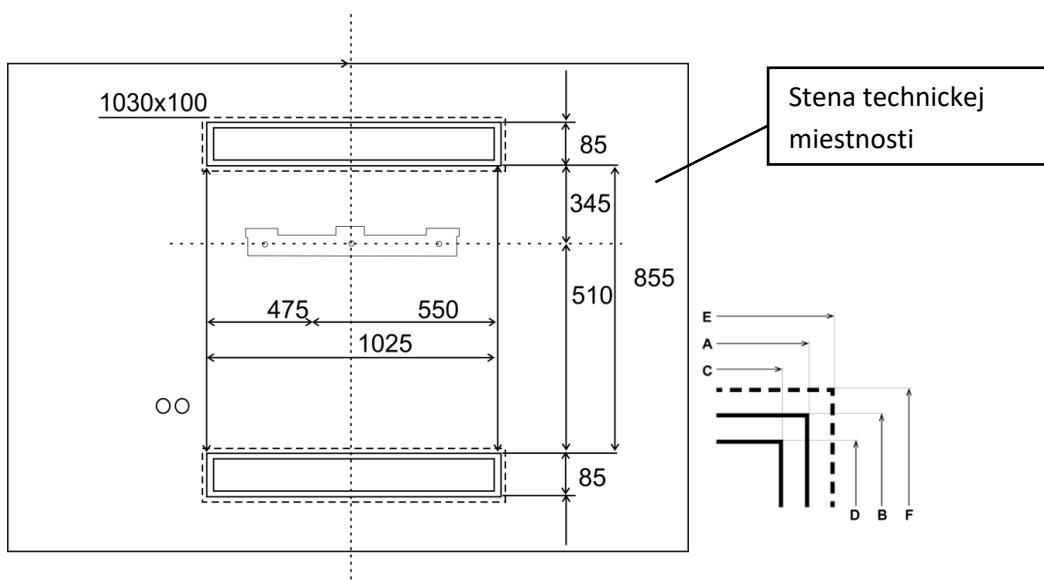
A – šírka stavebného otvoru = 1025 mm
