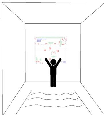
2. Pomocou montážnej šablóny a vodováhy si naznačte všetky diery ktoré bude potrebné vyvŕtať. Nezabudnite použiť vodováhu. Odporúčame pripojiť zariadenie z bezpečnostných dôvodov ešte dvomi skrutkami v pravom a v ľavom hornom rohu - umiestnenie nájdete na inštalačnej šablóne.
