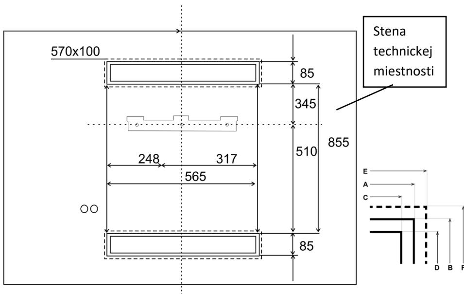
A – šírka stavebného otvoru = 565 mm
