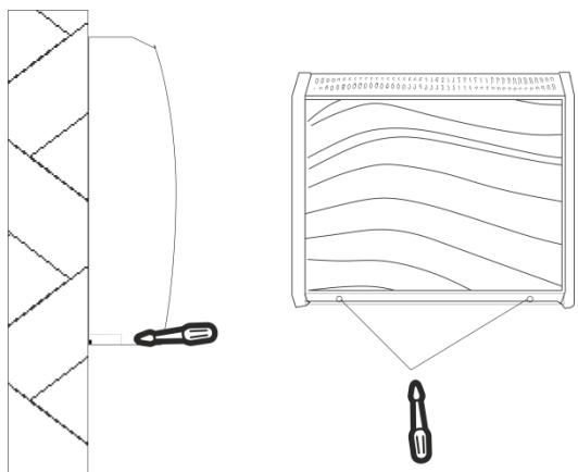
8. Teraz bude potrebné demontovať kryt odvlhčovača, aby ste mohli zapojiť elektrické pripojenie a odvod kondenzátu. Kryt je možné demontovať po uvoľnení 2 skrutiek (u DRY 300/400 Wave) a 3 skrutiek (u DRY 500 Wave) v spodnej časti zariadenia.
