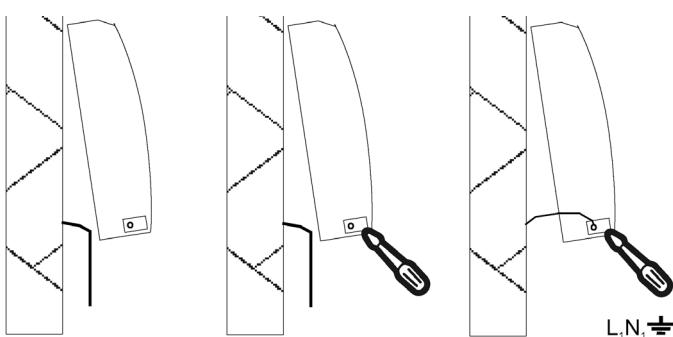
**11.** Pripojte kábel prívodu elektrickej energie. Pre tento účel je v zadnom plechu zariadenia vytvorená prechodka. Zariadenie sa pripája 230VAC/1f L,N, zemnenie . Prosím postupujte podľa časti 5.4 Pripojenie hlavného elektrického napájania.
