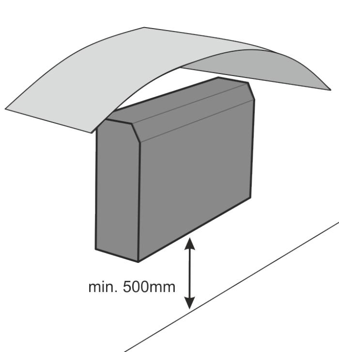
Dodržujte min. 500 mm vertikálnu vzdialenosť od zeme (zem, chodník, ...), aby sa umožnil voľný odtok kondenzátu a zabránilo ponoreniu do snehu alebo mláky.
