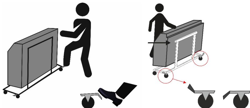
*Obr. Po presunutí odvlhčovača na mobilnom stojane na miesto inštalácie, zaistite brzdu kolies. Brzda kolies je zaistená, keď je páčka brzdy dole. Brzda kolies je odistená, keď páčka je hore.*
