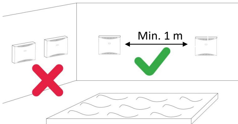
4. Vždy inštalujte odvlhčovač tak aby mohol odvlhčovať vzduch z bazéna. V prípade štruktúrovanej bazénovej haly, prípadne oddelenej časti – umiestnenie odvlhčovacieho zariadenia do tohto priestoru nie je vhodné nakoľko prúdenie vzduchu nebude dostatočné a tým sa nemusí dosiahnuť požadovaný efekt riadenia vlhkosti.
