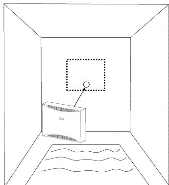
1. Priložte montážnu šablónu na stenu. Pred montážou odvlhčovača musia byť všetky stavebné práce (maľovanie, obklady, vykurovanie, odtok, elektrika) ukončené.
