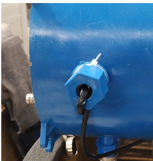
T4 – výtlačná teplota kompresora
