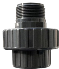
Obrázok 1: Matica hadice s externým závitom PN16. G=6/4" D=50mm
